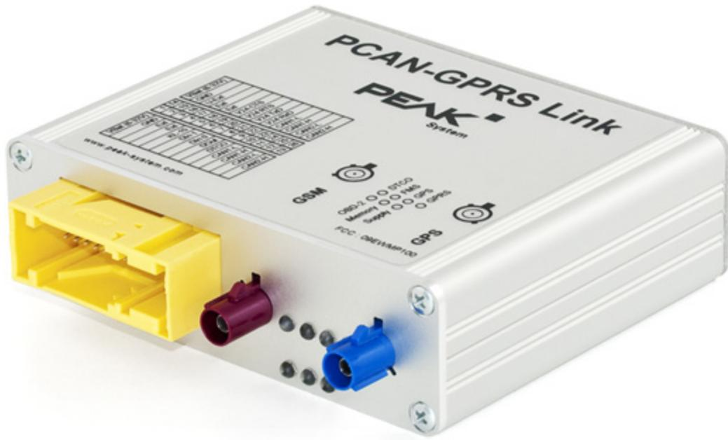
PCAN-GPRS Link 는 차량 데이터의 기록과 전달을 위한 하드웨어이자 펌웨어 플랫폼입니다. 내부 차량 데이터를 처리하는 장치 안에 두 개의 자유롭게 프로그램이 가능한 마이크로컨트롤러들이 있습니다.
