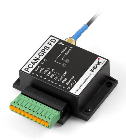
PCAN-GPS FD 는 CAN FD 연결을 통해 위치 및 방향을 결정할 수 있도록 사용자가 프로그램할 수 있는 센서 모듈입니다. 이 모듈에는 위성 수신기, 자기장 센서, 가속도계 및 자이로스코프가 들어있습니다. 수신되는 센서 데이터는 NXP 마이크로컨트롤러 LPC54618 에 의해 처리된 후 CAN 또는 CAN FD 를 통해 전송됩니다.
